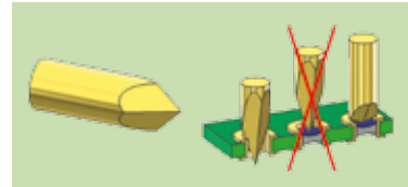
Mehrkant (15,30,33,38,43,62) Für Durchkontaktierungen und Padflächen. Die scharfen Kanten durchdringen auch Flussmittelrückstände und Oxidschichten.
