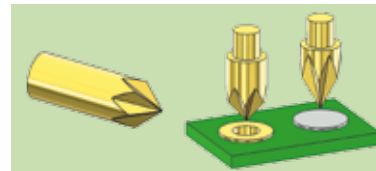
Sechskant (07,08) Für Durchkontaktierungen, Kontaktflächen und Löt pads. Die scharfen Kanten durch- schneiden auch Schmutz- und Oxidschichten.
